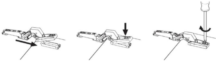
Fig. 3 Justering av dørhengsler
